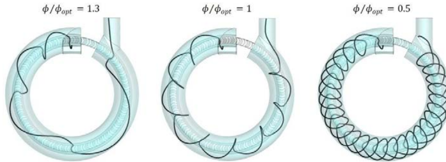
شکل (۱۶): خطوط جریان در ضرایب دبی \phi/\phi_{opt} = 1.3 و \phi/\phi_{opt} = 1 ، \phi/\phi_{opt} = 0.5
