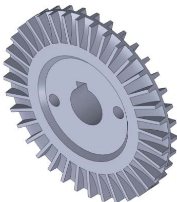
شکل (۴): هندسه پروانه پمپ رژنراتیو با پره‌های شعاعی
