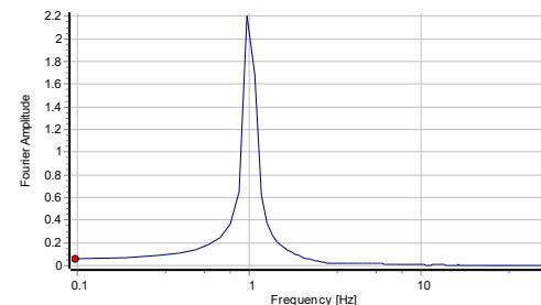
شکل (۱۹): دامنه فوریه برای بار سینوسی با فرکانس ۶/۴ هرتز و دامنه ۰/۶ متر بر مجدور ثانیه
