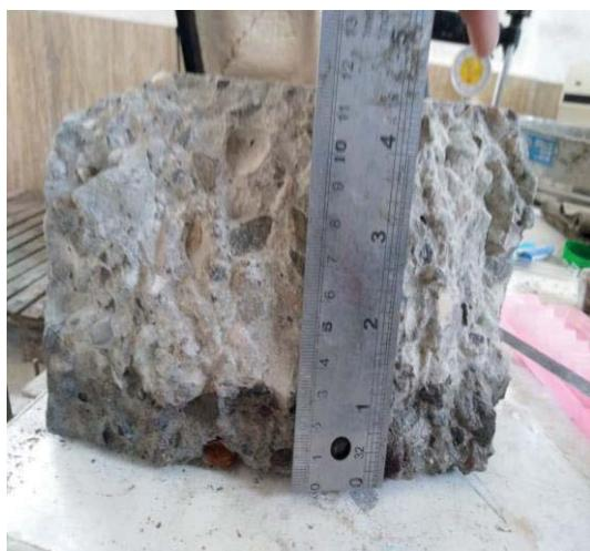
شکل(۶) : اندازه گیری ارتفاع نفوذ آب در آزمایش نفوذپذیری
