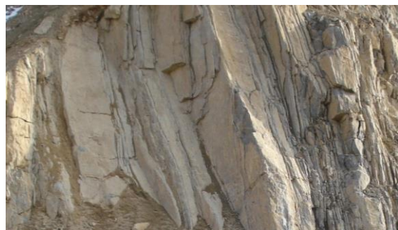
شکل ۴: واحد ماسه‌سنگی موجود در محل سازه‌های زیرزمینی طرح تلمبه ذخیره‌ای آزاد که در سطح زمین رخنمون یافته
