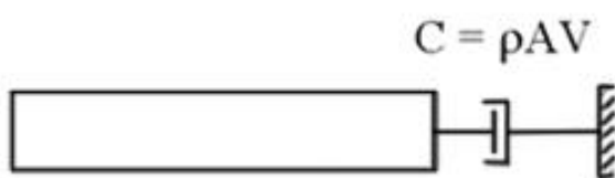
شکل (۲): (b) شیوه تعریف میرایی لیزمر
