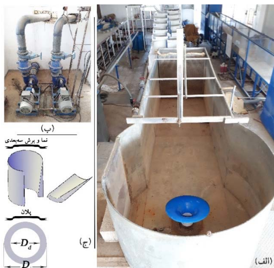
شکل (۲): نمایی از مجموعه تجهیزات آزمایشگاهی الف: مخزن و سرریز مورد استفاده ب: ایستگاه پمپاژ آزمایشگاه ج: شماتیک منحرف کننده‌ی جریان با نسبت A_d/A_i معادل ۰/۵
