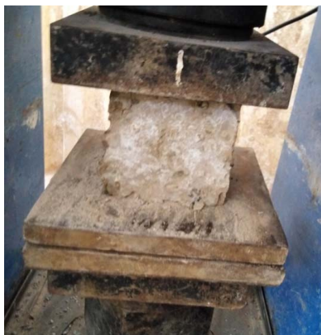
شکل (۳): بتن در حال انجام آزمون مقاومت فشاری
