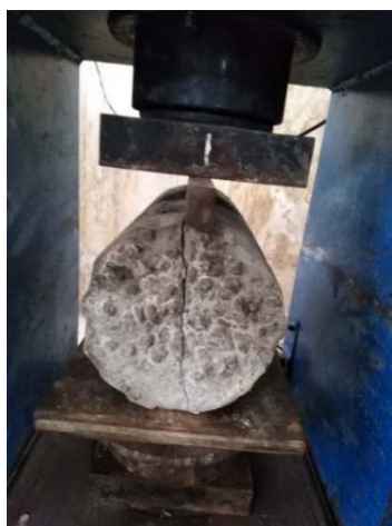
شکل (۵): بتن در حال انجام آزمون مقاومت کششی
