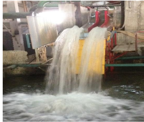
شکل (۲): نحوه تشکیل و ترکیب جت های موازی
