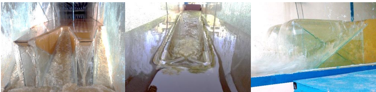
شکل (۳): جریان عبوری از روی سرریز در حین انجام آزمایش
