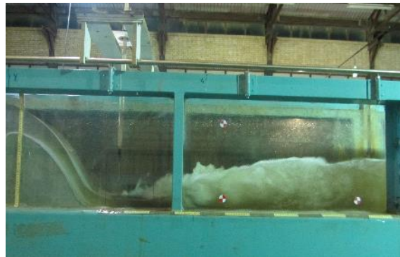
شکل (۴): پرش هیدرولیکی در مدل سرریز اوجی استاندارد
