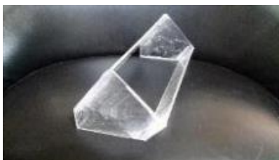
شکل (۶): سازه خروجی تخلیه تحتانی با زاویه ۳۰ درجه
