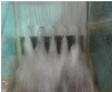
شکل (۲۲) جداسازی عرضی جریان روگذر برخورد کرده با تیغه‌ها
