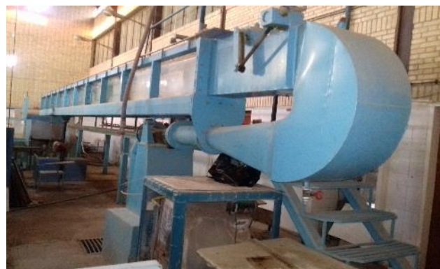
شکل (۳): مجموعه آزمایشگاهی و فلوم ۲۵ سانتی‌متری
