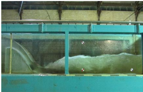
شکل (۵): پرش هیدرولیکی در مدل سرریز اوجی تخلیه دار
