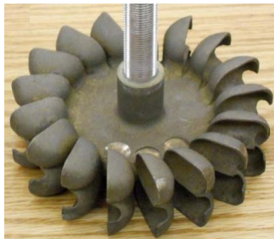
شکل (۱): تیغه های رانر در توربین پلتن
