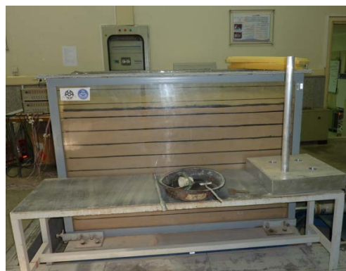
شکل (۵): جعبه میز لرزه پر شده از ماسه فیروزکوه به همراه رادیه و شمع
