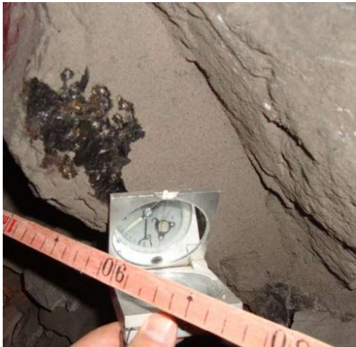
شکل (۱۲): پرشدگی لایه‌بندی توسط بیتومین
