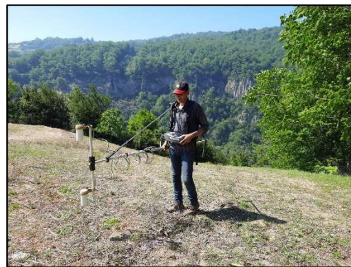
شکل (۴): نحوه بررسی مغناطیس‌سنجی در محوطه باستانی ولم با استفاده از دستگاه مغناطیس‌سنج سزیم-ربیدیم
