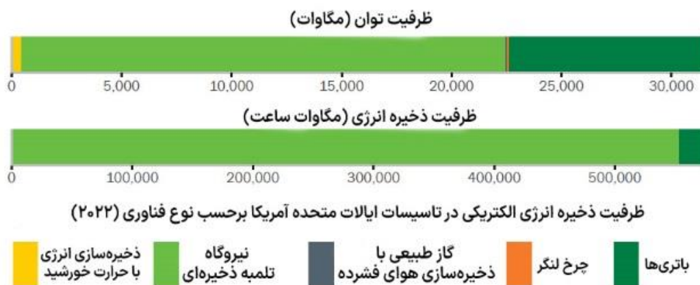
شکل (۲): ظرفیت ذخیره انرژی الکتریکی در تاسیسات ایالات متحده در سال ۲۰۲۲، منبع: اداره اطلاعات انرژی (EIA)
