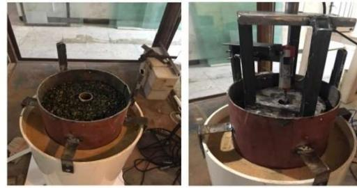
شکل (۴): مدل سازی آزمایشگاهی، (الف) سربار پی صلب، (ب) سربار خاکریز
