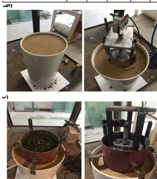
شکل (۴): مدل سازی آزمایشگاهی، الف) سربار پی صلب، ب) سربار خاکریز
