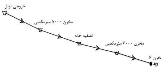
شکل (۱) پروفیل سامانه‌ی خط انتقال آب از سد صفارود همان‌طور که در شکل (۱) مشاهده می‌شود، این بخش شامل چهار قطعه است. قطعه‌ی اول، از خروجی تونل تا مخزن ۵۰۰۰ مترمکعبی، قطعه‌ی دوم، از مخزن ۵۰۰۰ مترمکعبی تا تصفیه‌خانه، قطعه‌ی سوم، از تصفیه‌خانه تا مخزن ۶۰۰۰ مترمکعبی و قطعه‌ی چهارم، از مخزن ۶۰۰۰ مترمکعبی تا مخزن شماره ۶ را شامل می‌شود.
