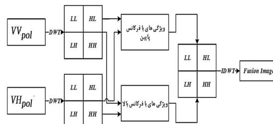
شکل (۲): روند کلی تلفیق قطبیدگی‌های HV و VV
