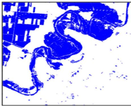
شکل (۶) : نقشه بدنه آبی مرجع برای تصویر SAR بعد از سیل
