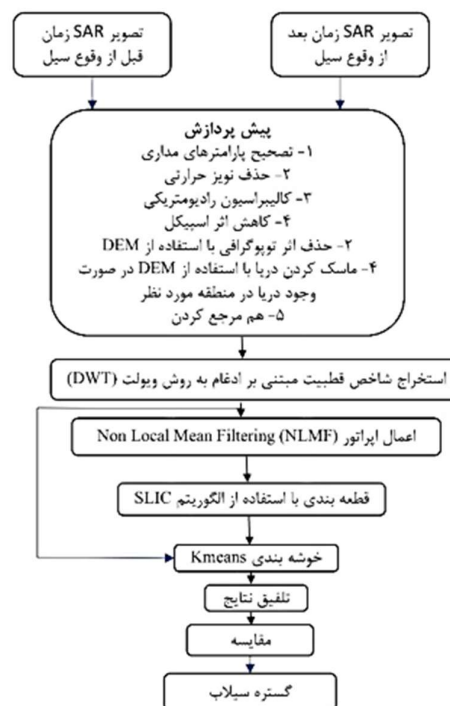
شکل (۳): فلوجارت روش پیشنهادی در جهت استخراج نقشه گستره سیلاب از تصاویر SAR
