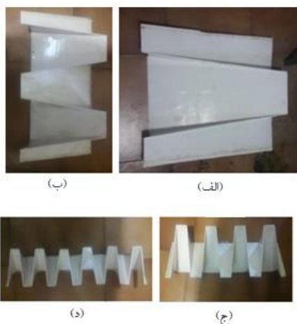
شکل (۵): سرریزهای مورد استفاده (الف): تک سیکل، (ب): دو سیکل، (ج): چهار سیکل و (د): شش سیکل
