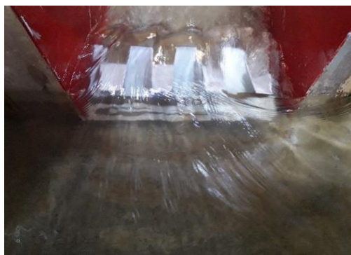
شکل (۳): سرریز جانبی چهار سیکل معکوس در شرایط آزمایشگاهی
