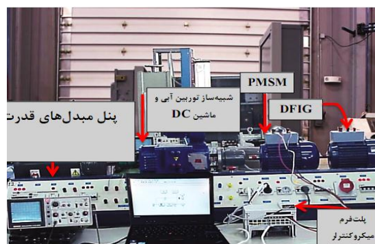
شکل (۱۱): تنظیم سیستم برای انجام آزمایش عملی
