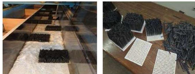
شکل(۲): تصویر برس های متعدد از لوله های پلی اتیلنی و نحوه چیدمان برس ها در کف کانال
