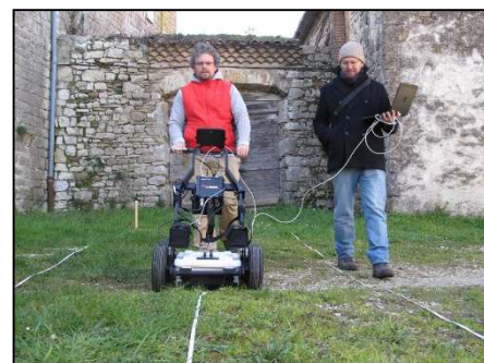
شکل (۷): نمونه‌ای از دستگاه رادار نافذ در زمین (عکس از کورش محمدخانی)
