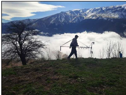
شکل (۱): بررسی مغناطیس‌سنجی با استفاده از دستگاه مغناطیس‌سنج سزیوم-رویدیم، محوطه خان باجی سرا ماسوله (عکس از بامشاد یغمایی)
