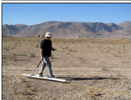
شکل (۵): بالا: دستگاه الکترومغناطیس مینی اکسپلورر CMD و پایین: دستگاه الکترومغناطیس GEM استفاده شده در محوطه میراث جهانی پاسارگاد- هیئت باستان‌شناسی مشترک ایران- فرانسه (عکس از کورش محمدخانی)
