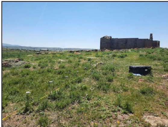
شکل (۳): نمونه‌ای از بررسی ژئوالکتریکی به روش توموگرافی (عکس از کورش محمدخانی)
