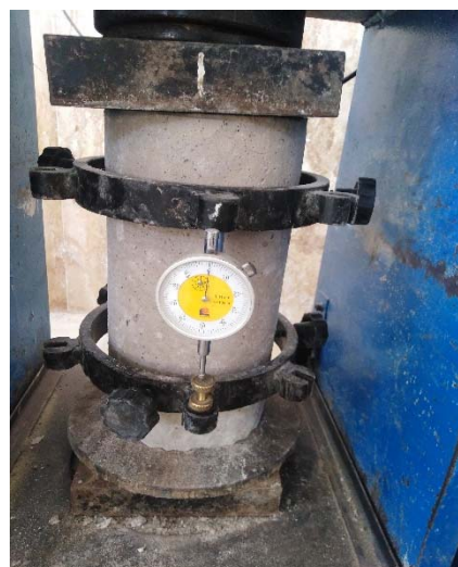
شکل (۲): بتن در حال انجام آزمون مدول الاستیسیته
