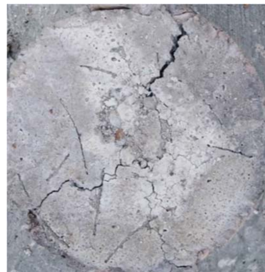
شکل (۵): نمونه بتنی حاصل از آزمون وزنه افتان
