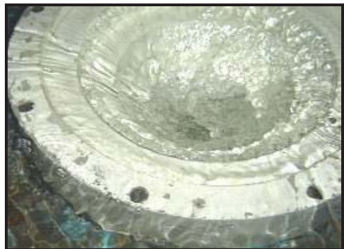
شکل (۴): نمایی تغییر رژیم جریان در سرریز نیلوفری با مجرای پلکانی
