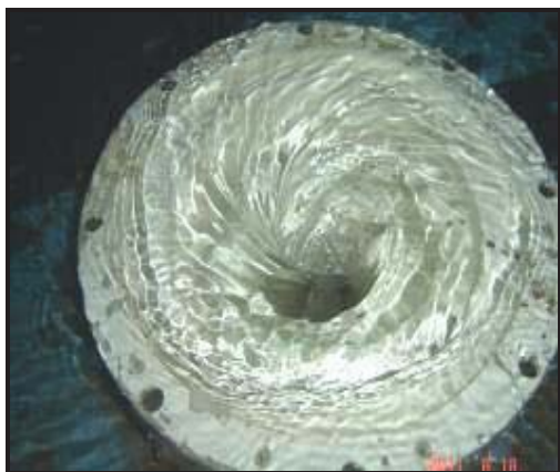
شکل (۵): نمایی تغییر رژیم جریان در سرریز نیلوفری با مجرای پلکانی (ایجاد حالت گردابه ای)
