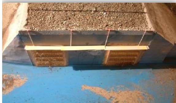
شکل (۱۱): مشخصات صفحه ضدگرداب در مدل آزمایشگاهی
