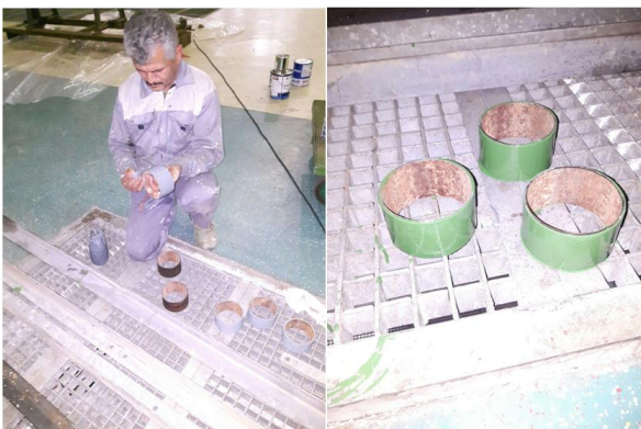
شکل (۳) نحوه رنگ‌آمیزی تکه‌های لوله بکار رفته در بدنه سد با رنگ‌های معمولی بکار رفته در سد و رنگ ارتقاء یافته توسط نانو ذرات اکسید تیتانیوم.
