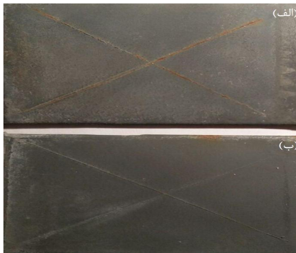
شکل (۹): آزمون پاشش به مدت ۵۰۰ ساعت توسط آب جمع‌آوری شده از خورنده‌ترین قسمت سد بر روی دو تکه لوله هم‌جنس در مدت ۶۰ روز که (الف) بارنگ معمولی و (ب) با رنگ ارتقاء یافته رنگ آمیزی شده است.
