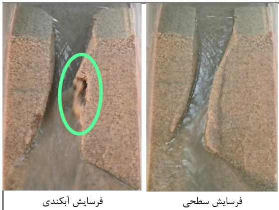
شکل (۶): فرسایش سطحی و آبکندی در آزمایش‌ها
