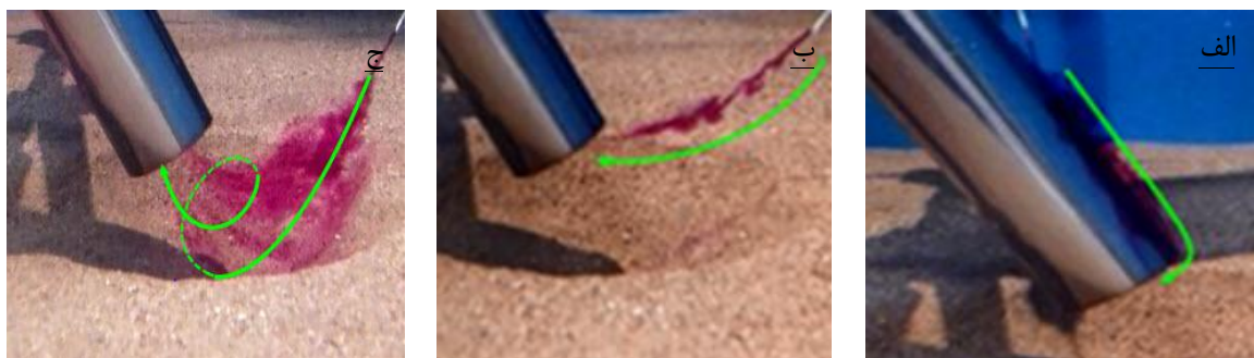
شکل (۷): جریان اطراف دهانه مکش؛ a، جریان مماس بر دهانه مکش؛ b، جریان میانی دهانه مکش و سطح رسوب؛ c، گردابه‌های جلوی دهانه مکش.
