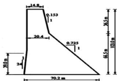
شکل (۱): ابعاد هندسی مقطع عرضی سد بتنی وزنی کوینا
