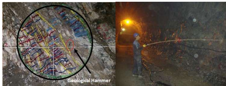
شکل (۴): (الف) مراحل شستشوی سطح تونل قبل از انجام عملیات برداشت درزه (ب) نمونه‌برداری دایره‌ای به قطر ۳ متر به همراه موقعیت خط برداشت
