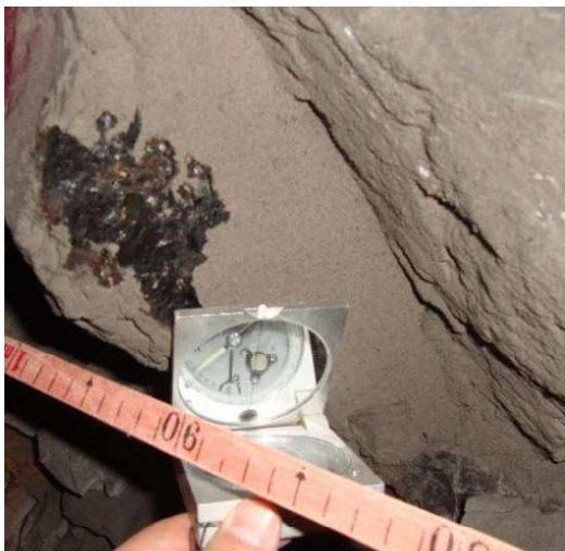
شکل (۱۲): پرشدگی لایه‌بندی توسط بیتومین
